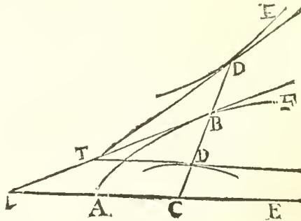
L X. E X E M P L E 1. Nommant AB,  $x$  ; BD,  $y$  ; soit  $ax = yy$ , donc  $a\dot{x} = 2y\dot{y}$  ; ainsi  $a : 2y :: y : \dot{x} :: BD : BT$ .
